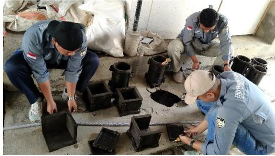
Gambar 1. Persiapan Benda Uji
