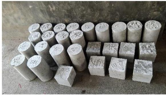
Gambar 5. Sampel Beton Setelah Perendaman 28 Hari
