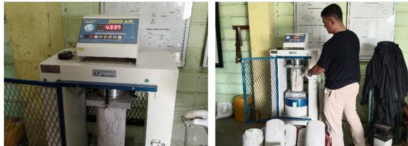
Gambar 6. Proses Pengujian Benda Uji
