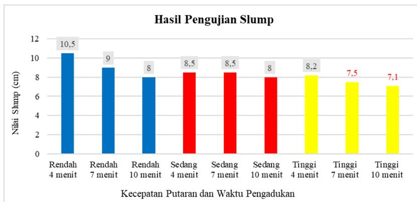
Gambar 7. Hasil Pengujian Slump Beton
