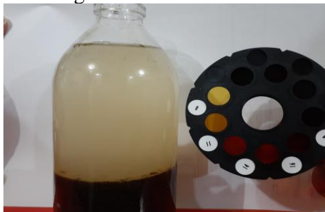
Gambar 1. Pasir brodot yang sudah dicampurkan NaOH 3% dan didiamkan selama 24 jam.
