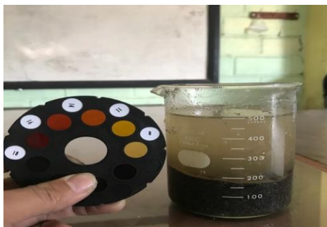
Gambar 1. Pasir brotot yang sudah dicampurkan NaOH 3% dan didiamkan selama 24 jam.
