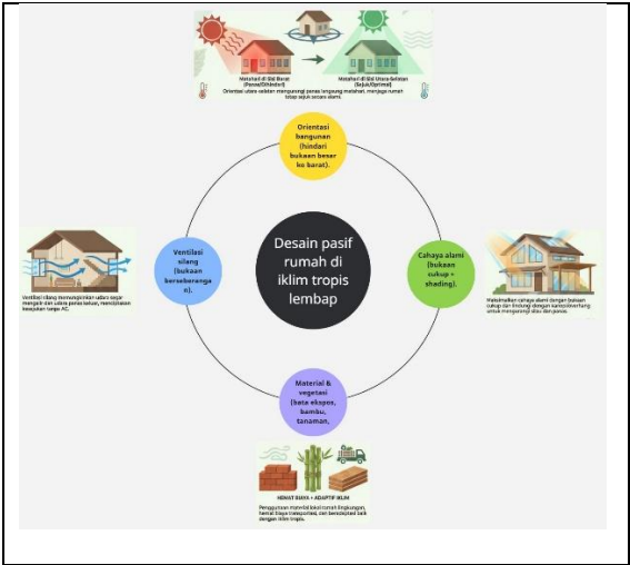
Gambar 4. Prinsip-prinsip utama desain pasif untuk rumah di iklim tropis panas lembap yang dijelaskan pada sesi desain berkelanjutan
