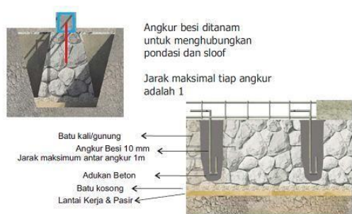
Gambar 7. Hubungan fondasi dengan balok pengikat bawah (sloof)
