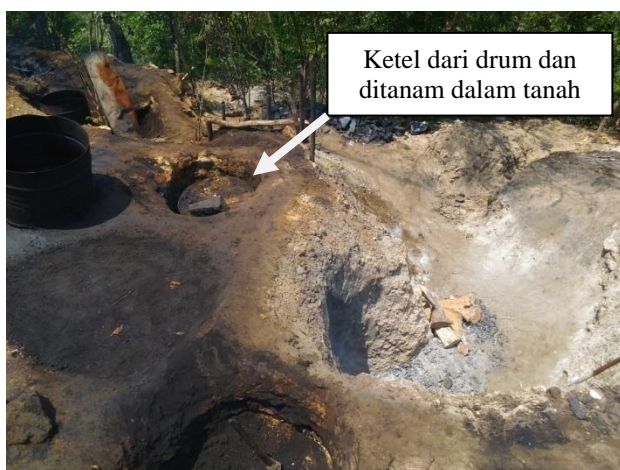
Gambar 2. Model ketel penyulingan tradisional
