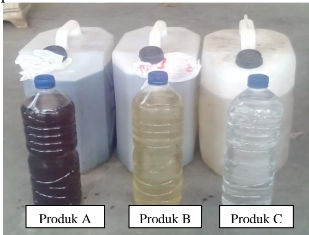
Gambar 8. Hasil destilasi bertingkat
