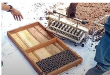
Gambar 3. Alat mencetak “Soil block” Sumber: dokumentasi pribadi
