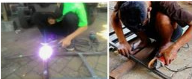
Gambar 3. Proses perakitan rangka
