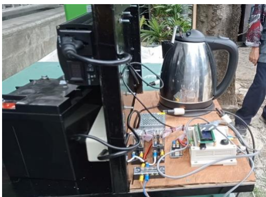
Gambar 2. Rangkaian IoT dan Bejana Air Asin.
