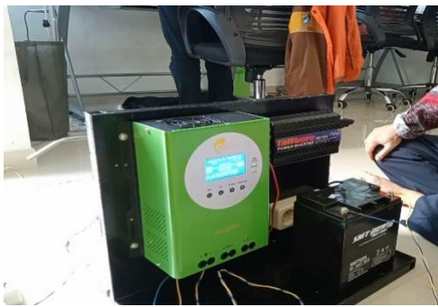
Gambar 1. Pengendali tenaga surya, MQTT.
