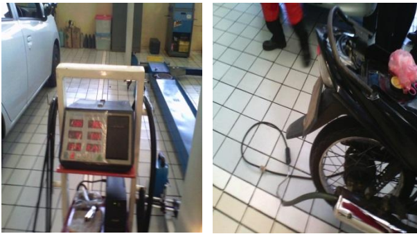
Gambar 8. Pengujian Emisi Gas Buang dengan engine gas analyzer
