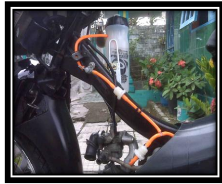
Gambar 3. Penempatan Water injection pada Sepeda Motor
