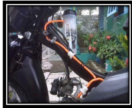
Gambar 3. Penempatan *Water injection* pada Sepeda Motor
