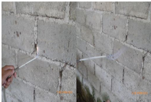
Gambar 9. Nyala api biogas tanpa dan dengan alat purifikasi
