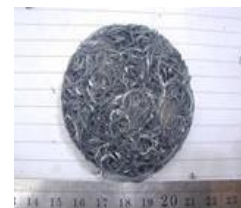
Gambar 4. Chip baja yang sudah dicetak menjadi bilet.
