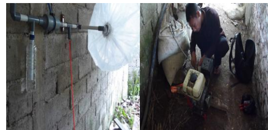
Gambar 11. Ujicoba Biogas pada Motor Bensin
