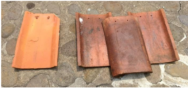
Gambar 14. Adaptasi Bentuk Profil U dan Lubang Material Genteng Gereja Puhsarang (Sumber: Penulis, 2025)
