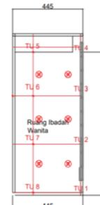
Gambar 6. Denah lampu dan denah titik ukur ruang ibadah wanita
