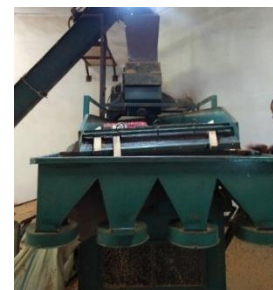
Gambar 3. 9 Lubang pemisah biji kopi pada mesin suton (Sumber : survei, 2022)
