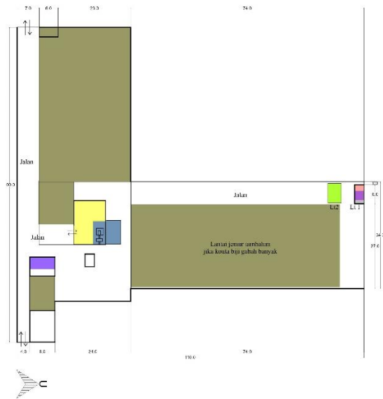
Gambar 3. 16 Zonasi ruang proses pengolahan kopi (Sumber : analisis, 2022)
