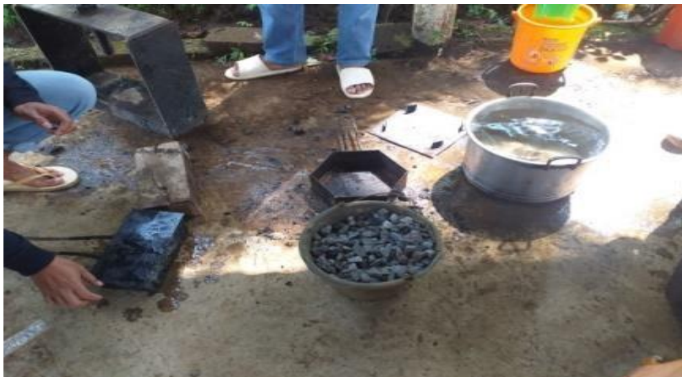
Gambar 4. Melepaskan Paving Block dari Cetakan
