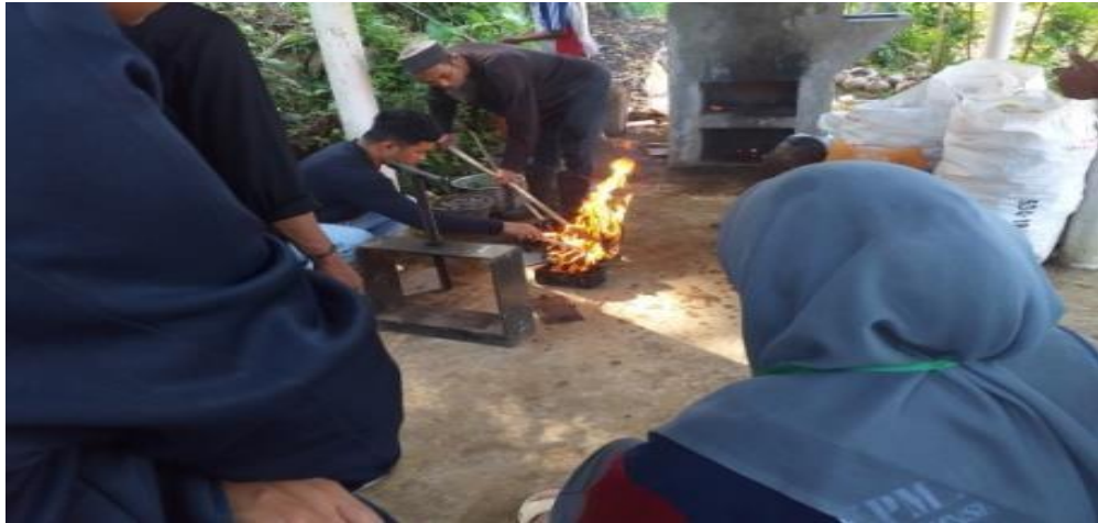
Gambar 3. Sampah yang Sudah Melebur Rata Dimasukkan Kedalam Cetakan Paving Block
