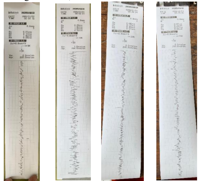
Gambar. 7. Hasil pengujian Kekasaran
