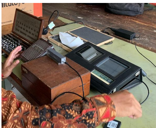
Gambar. 6. Proses pengujian Kekasaran
