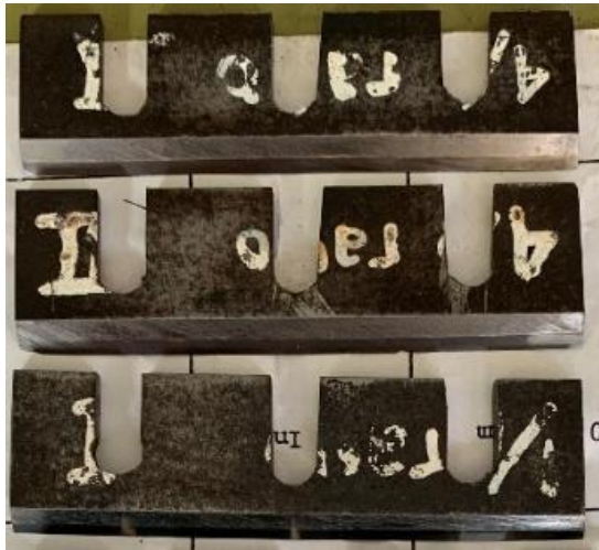
Gambar. 5. Mata Pisau Planer Sebagai Spesimen Uji
