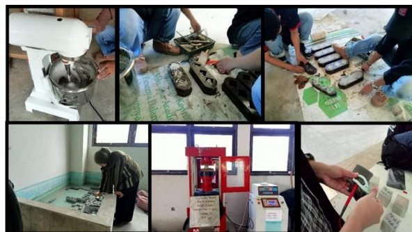
Gambar 3. Proses Pembuatan dan Perawatan: Mixing, Pencetakan, Pemadatan, Curing, dan Pengujian
