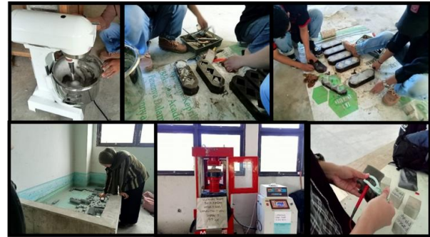
Gambar 3. Proses Pembuatan dan Perawatan: Mixing, Pencetakan, Pemadatan, Curing, dan Pengujian
