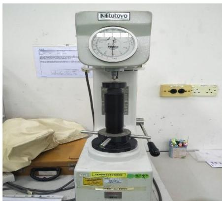
Gambar 2. Alat Pengujian Kekerasan *Rockwell*
