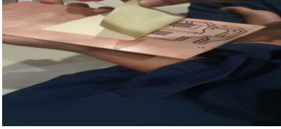
Gambar 5 Pembuatan Desain PC
