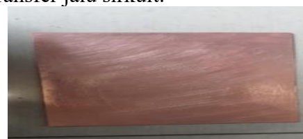
Gambar 4 Persiapan PCB Polos
