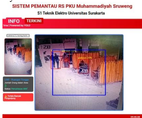
Gambar 6 Implementasi Model Deteksi Kerumunan Menggunakan Yolo
