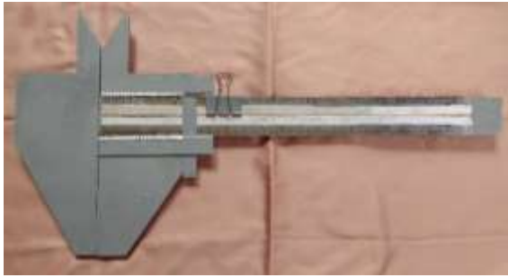
Gambar 1. Large size vernier caliper yang digunakan untuk mengukur diameter luar dan kedalaman suatu benda
